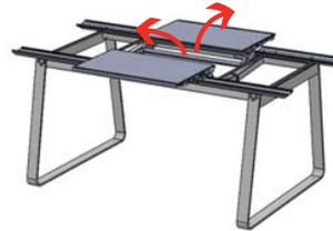
**2** Dévisser légèrement les vis de butée sous les glissières pour pouvoir installer les plateaux latéraux.
