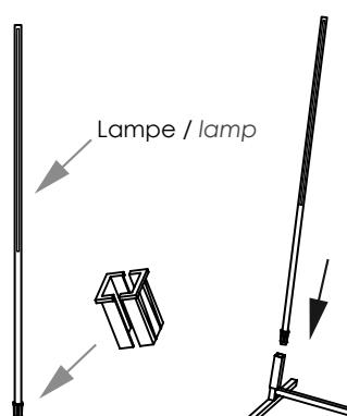
Mettre les 2 pièces de protection plastiques en bas de la lampe puis insérer l'ensemble dans le support.
